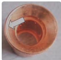
バリ取り不足による段差
