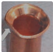
加工後の衝撃による変形
