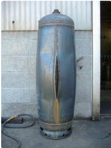
破壊試験により破裂した100kgボンベ(例)
